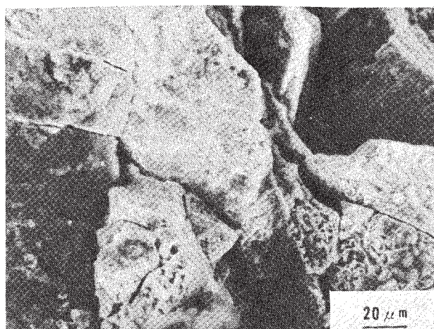
Fig. 4 ミクロ破面の一例（管表面より10mm内側）
