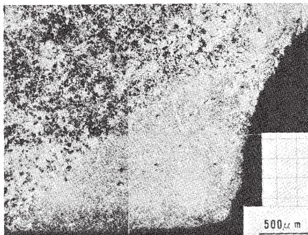
Fig. 3 破面 A の破壊起点部近傍のマイクロ組織
