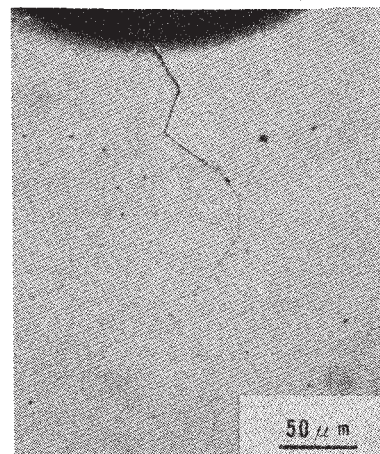
Fig. 2 HT100再現熱影響部の高温ミクロ組織 ( \sigma_a=15.3\text{kgf/mm}^2 , 580^\circ\text{C} )
