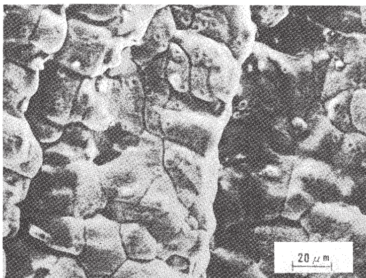
Fig. 4 Fig. 3の中央部を拡大したミクロ破面
