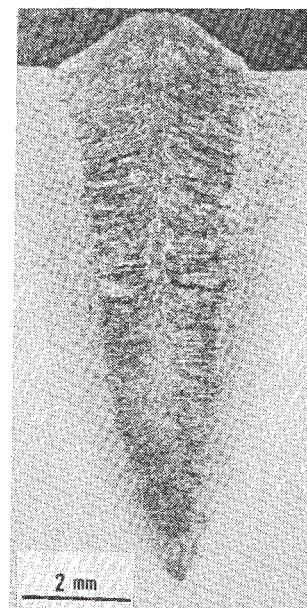
Fig. 2 溶接部横断面マクロ組織
