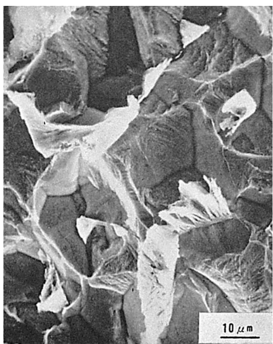
Fig.4 初期欠陥部のマイクロ破面
