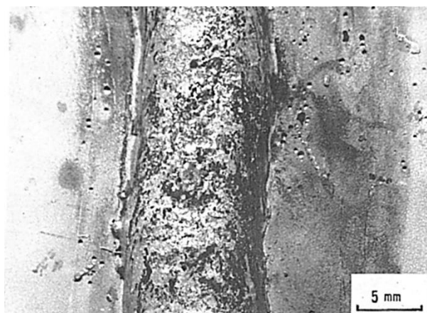
Fig.6 SUS201 鋼の溶接 HAZ に発生した孔食のマクロ写真 (3%NaCl 水 (20℃) に長期浸漬)
