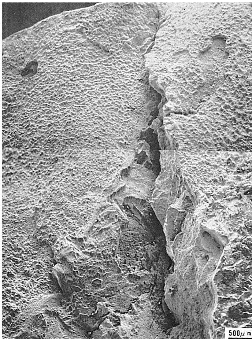
Fig.3 割れ部の断面マクロ写真
