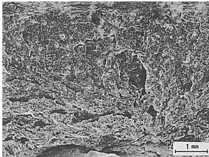
Fig.2 延性破面 (−100°C)
