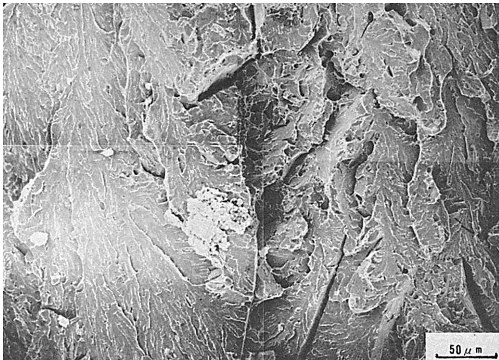
Fig.2 上部ベイナイト組織を呈する溶接金属の衝撃破面 （試験温度 -30^{\circ}\text{C} ，吸収エネルギー 2.4\text{kgf}\cdot\text{m} ）
