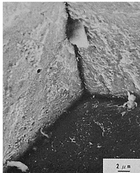
Fig.4 HT100 の再現 SR 割れのマイクロ破面
