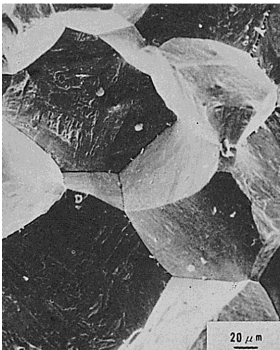
Fig.4 HT100 の再現 SR 割れのマイクロ破面
