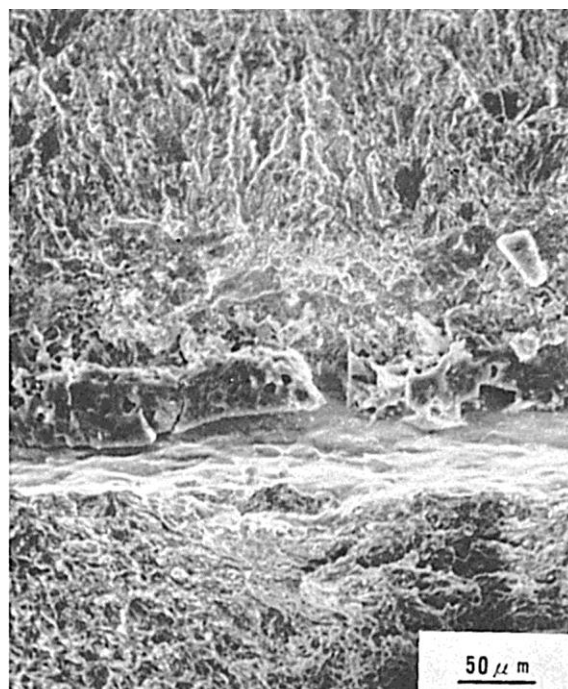
(a) 脆性破壊の起点のマイクロ破面
