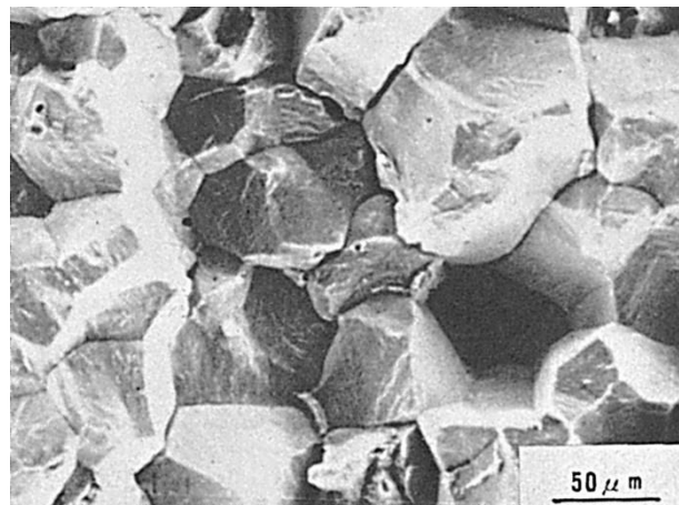
Fig.2 電子ビーム溶接ボンド部に発生したSR割れの マイクロ破面
