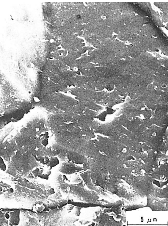
Fig.5 水素粒界破面（ビート中央部）
