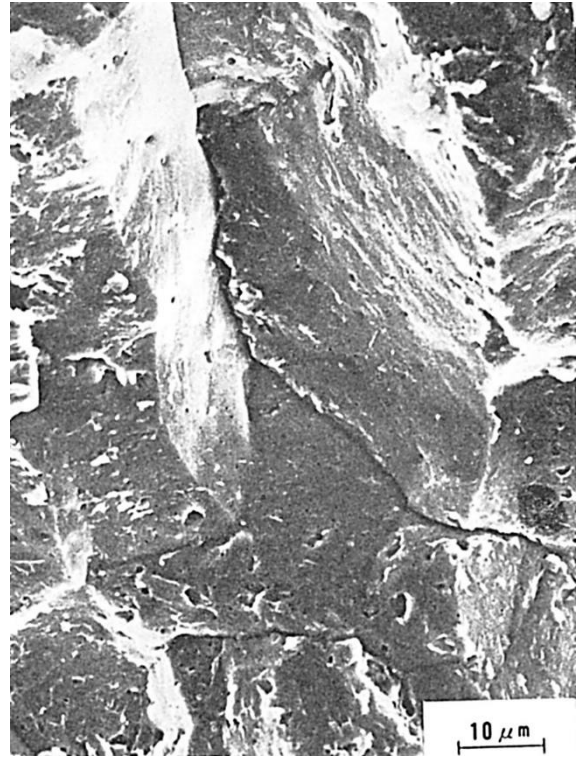
Fig.4 水素粒界破面（ビート中央部）
