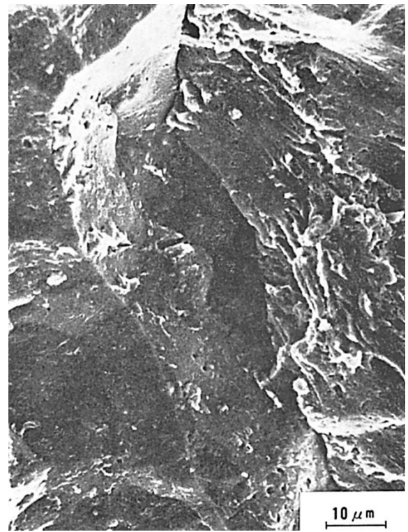
Fig.6 水素粒界破面と部分的に水素擬へき開破面が認められる．（ビート表面近傍）
