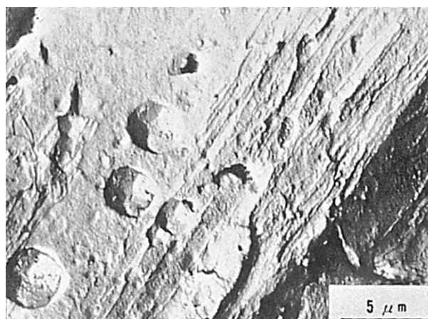
Fig.1 低温脆性破面のエッチピット形状, {110} 面を示す. (HT80, マルテンサイト組織, 三点曲げ試験 -196°C)
