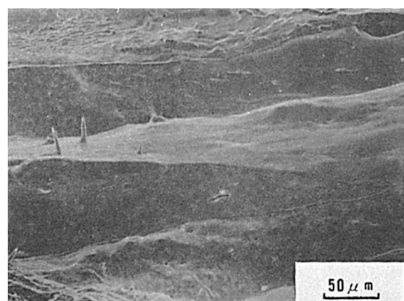
Fig.6 凝固割れのマイクロ破面の例
